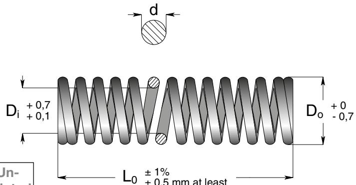
**D<sub>o</sub>** Diametro esterno della molla - Spring outside diameter
